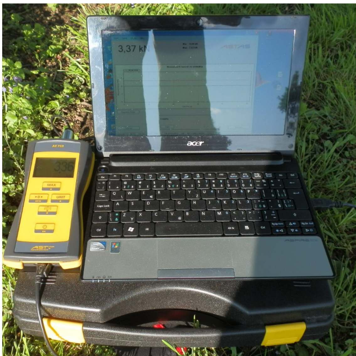
Obrázek 3: Aparatura pro měření síly v systému slackline
